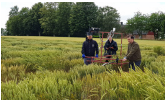
Genom att rulla en vagn utrustad med sensorer över ett fält går det att samla in data på ett snabbt och systematiskt sätt. FOTO: AAKASH CHAWADE
